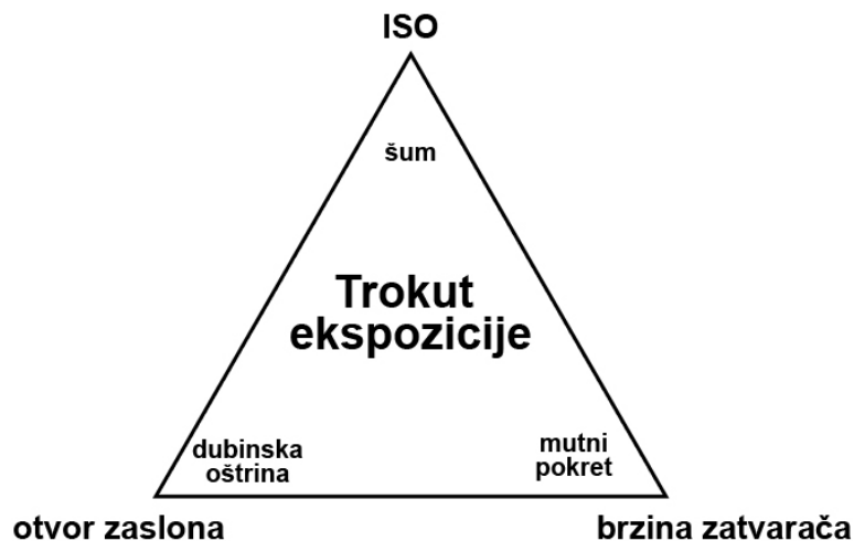
Slika Međuovisnost otvora zaslona – brzine zatvarača – ISO osjetljivosti
