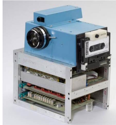
Slika 10. Prvi fotoaparat sa CCD senzorom
